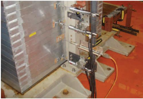
写真-4 水平変位計土槽側面 設置状況
