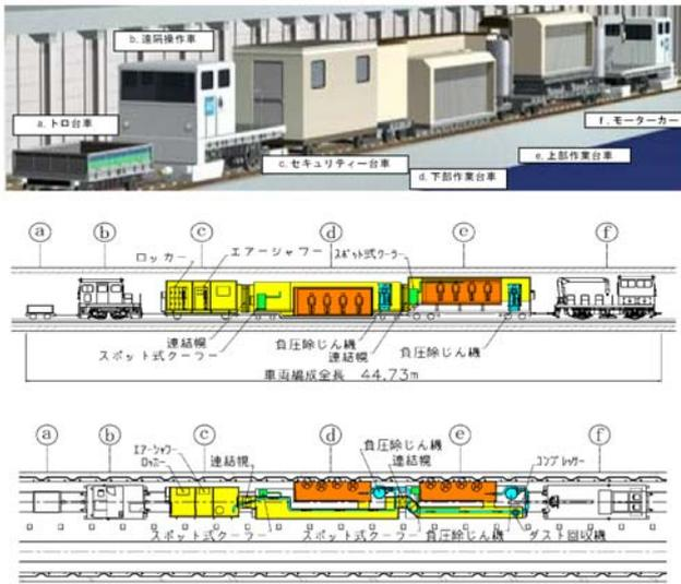
図-1 トンネル部 石綿除去専用車両
