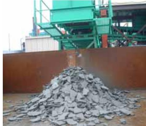
写真-2 脱水処理土<sup>2)</sup>
