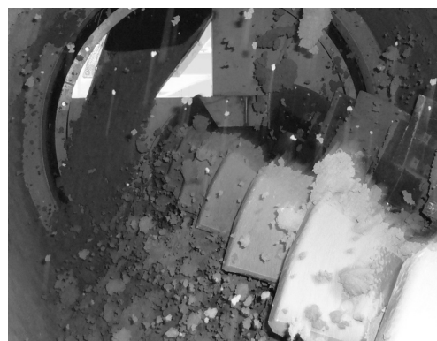
写真-10 混合状況 ドラムとパドルが逆方向に回転
