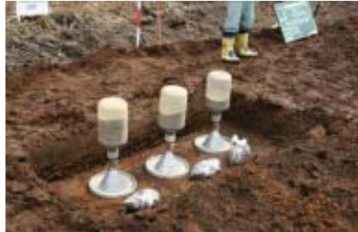
写真-1 深度30cmでの砂置換状況
