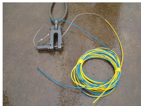
写真-8 鉄筋かごの伸展用ワイヤーの玉掛け装置
