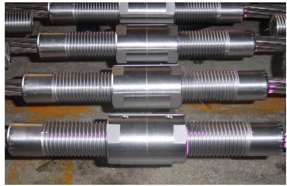
写真-4 カプラーによるマンションの接続
