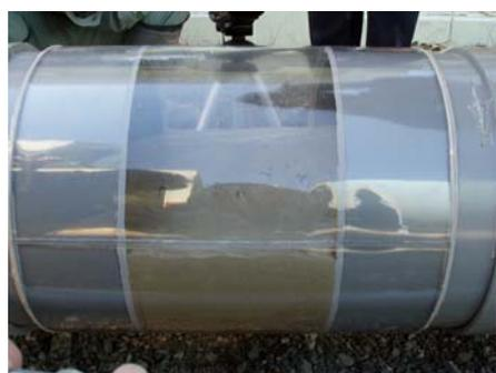
写真-5 エアモルタルの流動状況 (透明管通過時)
