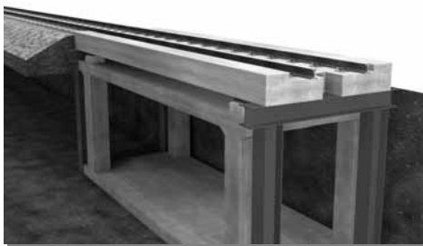
図-8 線路下掘削，構造物築造
