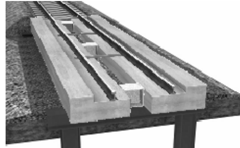
図-7 中間横桁，右側主桁セット
