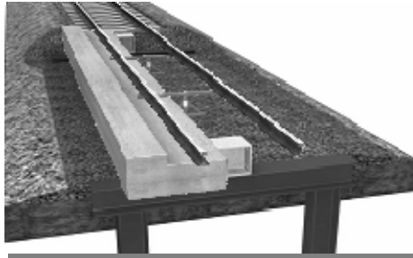
図-6 枕木撤去，バラスト掘削
