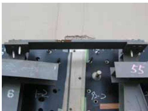
写真-4 据付用治具
