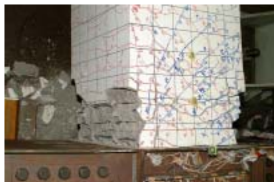
図-16 柱脚部の破壊状況（载荷終了時）
