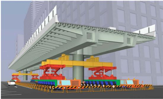
図-5 ドローリによる一括移動架設
