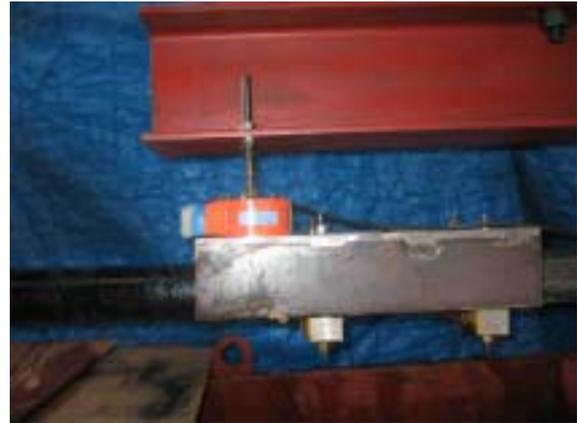
写真-2 ロードセル設置状況
