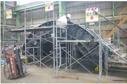
写真-4 高剛性鋼製型枠
