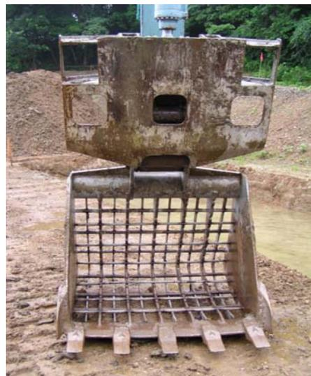
写真-4 解砕バケット（スケルトンバケット+押土板）
