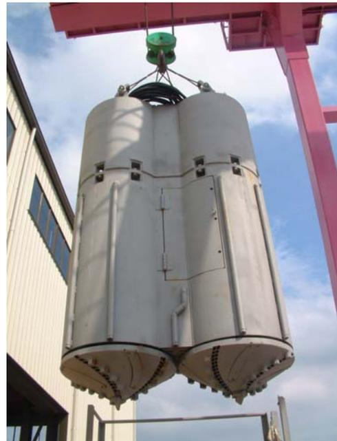
写真-1 掘削機外観(2分の1モデル試験機)
