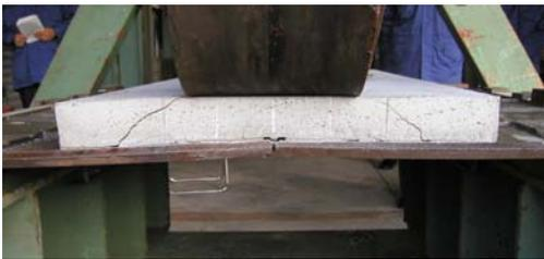
写真-9 継手曲げ試験（正方向）
