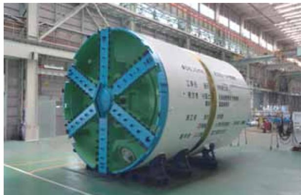
写真-1 5.6m 泥土圧シールド機
