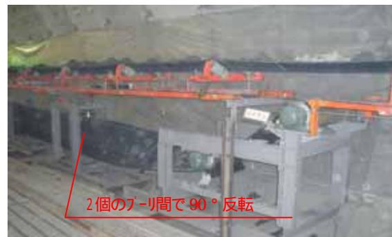
写真-6 R35m区間リターン側ベルト反転装置
