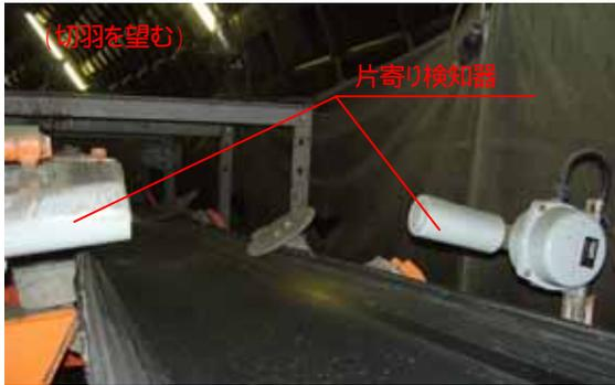
写真-9 ベルト片寄り検知器 (両側設置)
