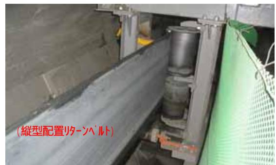
写真-7 R35m 区間リターンベルト縦型配置
