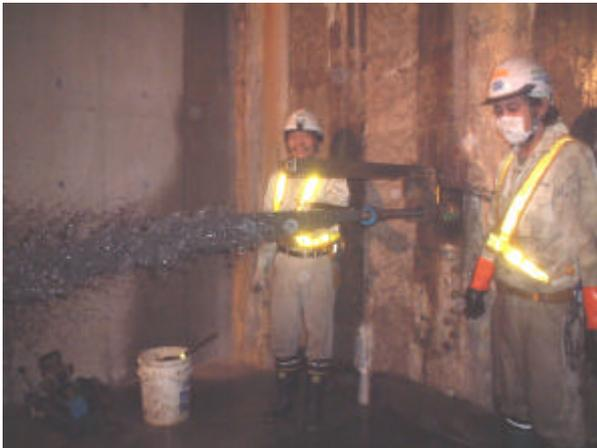
写真-1 湧水量確認試験状況
