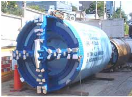
写真-8 φ1800 泥濃式回収型掘進機
