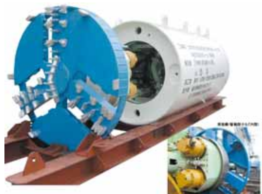
写真-5 φ2130 簡易解体・回収型シールド機
