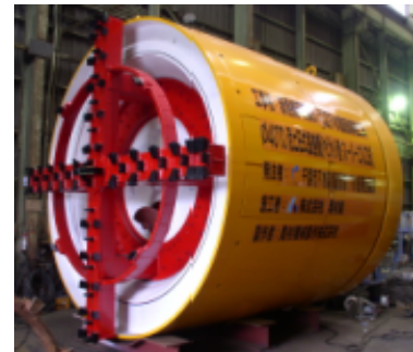
写真-1 φ4070 簡易解体・回収型掘進機
