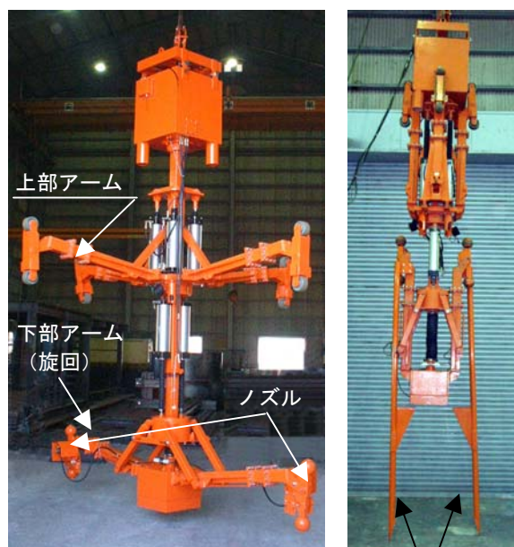
解体アタッチメント
