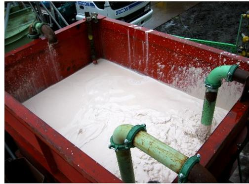
写真-1 Mg系固化材スラリー作製状況
