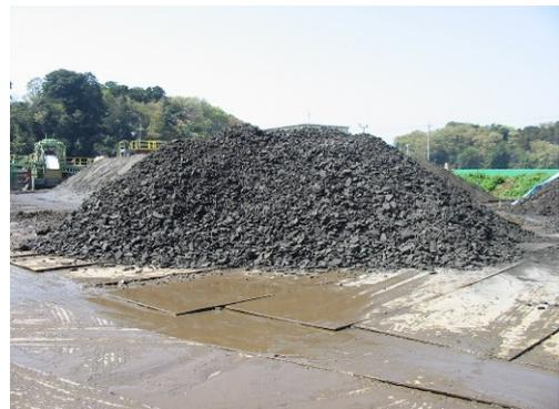
写真-3 作製後脱水ケーキの仮置き状況
