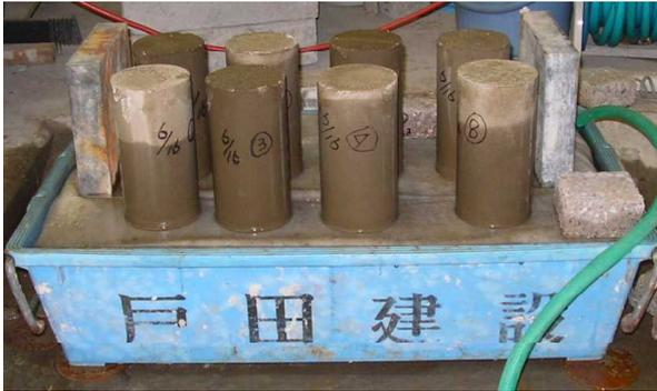
写真-2 第一試験状況 (24時間吸水後)
