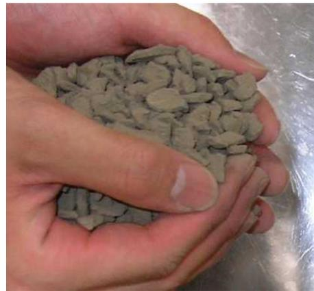
写真-1 浄水発生土（乾燥状態）
