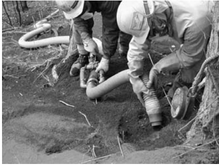
写真-4 強力空気搬送機使用状況
