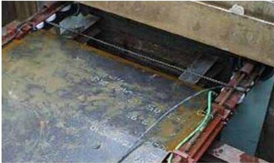
写真-2 地盤切削・鋼板挿入試験状況(発進立坑)
