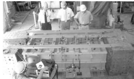
写真-7 切削可能部材設置セグメント外水圧作用試験状況
