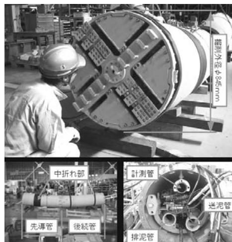
写真-3 太径曲線掘削機
