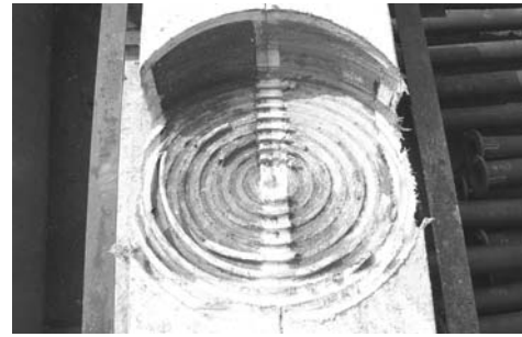
写真-6 下向き実大規模実証実験の切削可能部材切削状況
