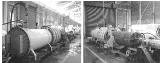
写真-8 高水圧に対応した止水エントランス実験
