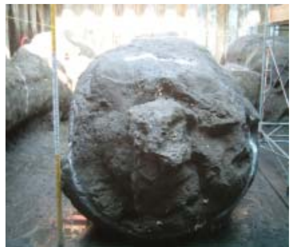
写真-3 掘出した改良体 Case7
