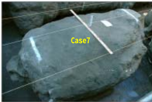
写真-1 掘出した改良体 Case7
