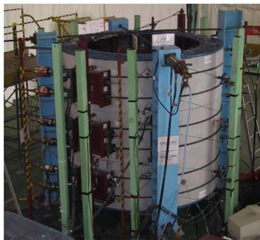
図-6 リング載荷試験状況
