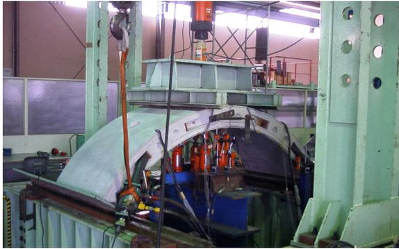
写真-1 継手曲げ試験状況
