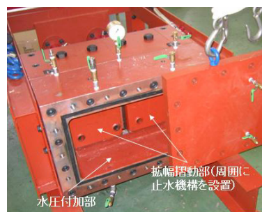
図-7 拡幅セグメント止水試験の概要
