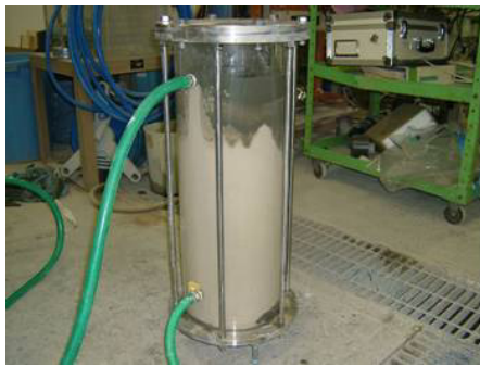
写真-1 泥水との置換試験 (試験途中の状態)
