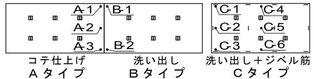
図-1 プレキャスト型枠のひずみ計測位置
