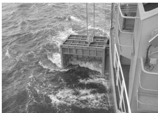
図-8 スキッパー式油回収器（高粘度油用）
