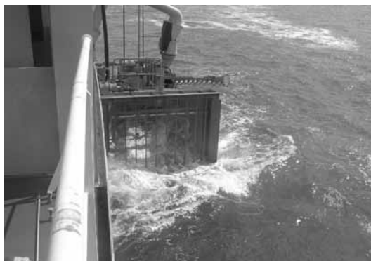
図-7 渦流式油回収器（低粘度油用）
