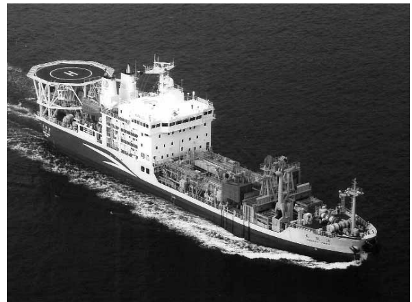
図-1 ドラグサクシヨン浚渫兼油回収船 「清龍丸」（平成17年4月就航）
