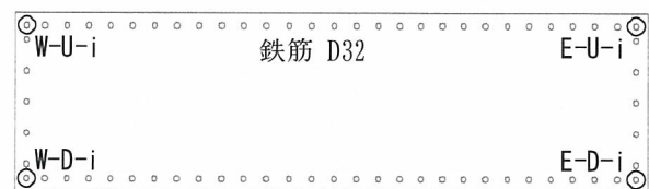
図-3 鉄筋ひずみ計設置位置図
