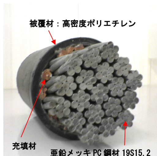
写真-9 外ケーブル断面
