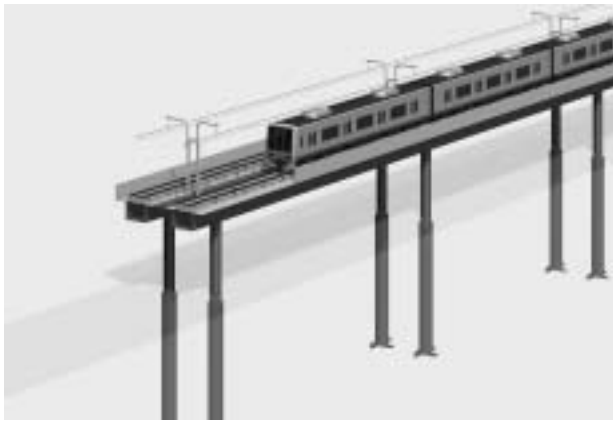
図-4 鋼製軌道支持梁タイプ
