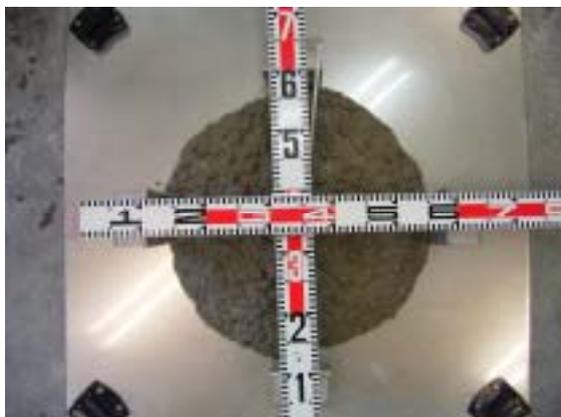
写真-1 スランブフロー試験結果
