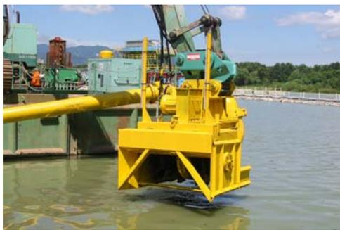
写真-1 真空吸引圧送システムの吸引口
