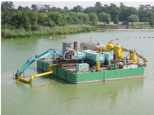
写真-2 浚渫台船(吸引能力：43.8m<sup>3</sup>/min.)
