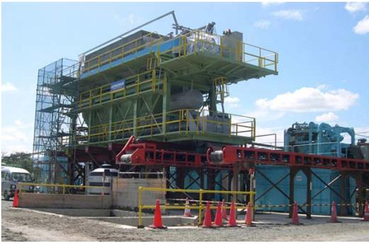
写真-4 高圧薄層フィルタープレス
