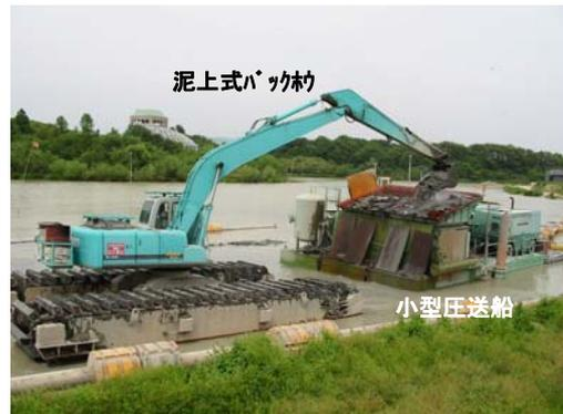
写真-3 泥上式バックホウ(バケット容量：0.7m<sup>3</sup>)
