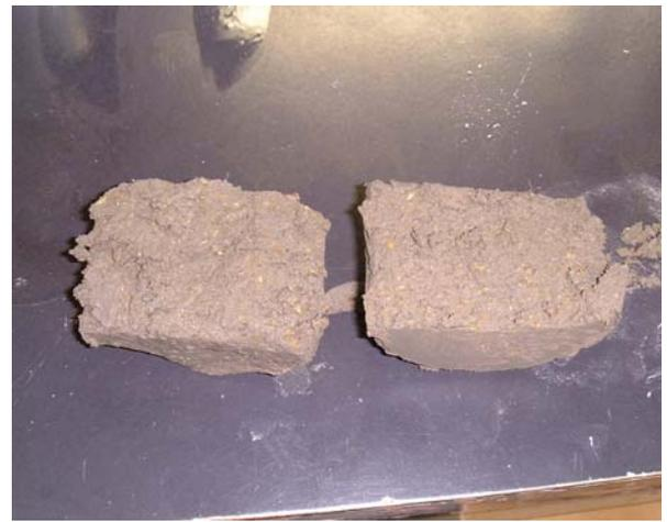
写真-8 脱水ケーキと粉末状発酵促進材の混合状況
