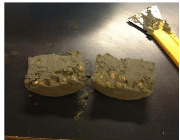
写真-9 脱水ケーキとペレット状発酵促進材の混合状況
