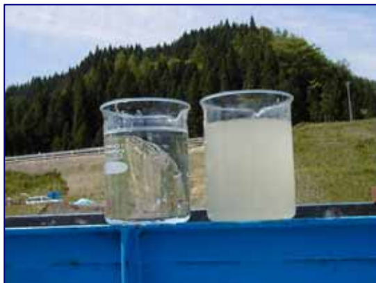
写真-3 濁水と処理水
