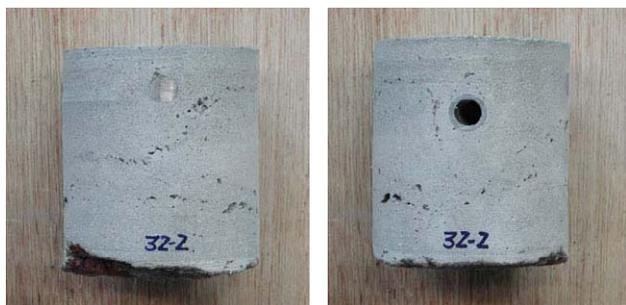
D13mm 鉄筋 (背面側)       $\phi 19\text{mm}$  塩ピ (表面側)
