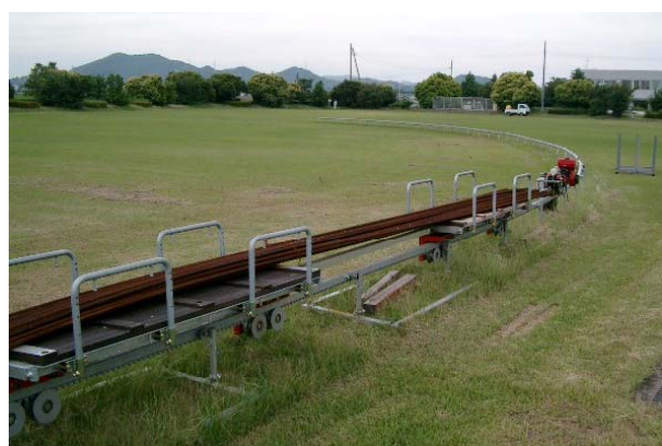
写真-4 走行試験状況（曲線桁）
