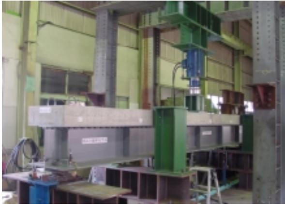
写真-1 合成桁の載荷実験状況
