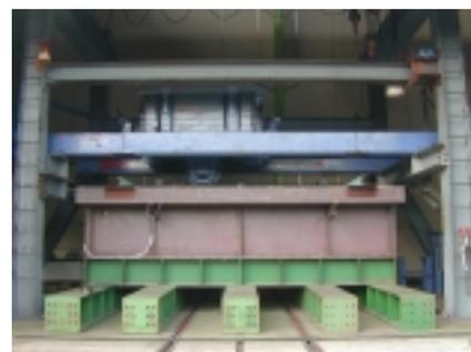
写真-3 移動輪荷重載荷実験状況
