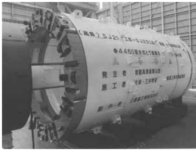
写真-1 撤去シールド機状況
