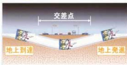
図-2 URUP工法の施工方法
