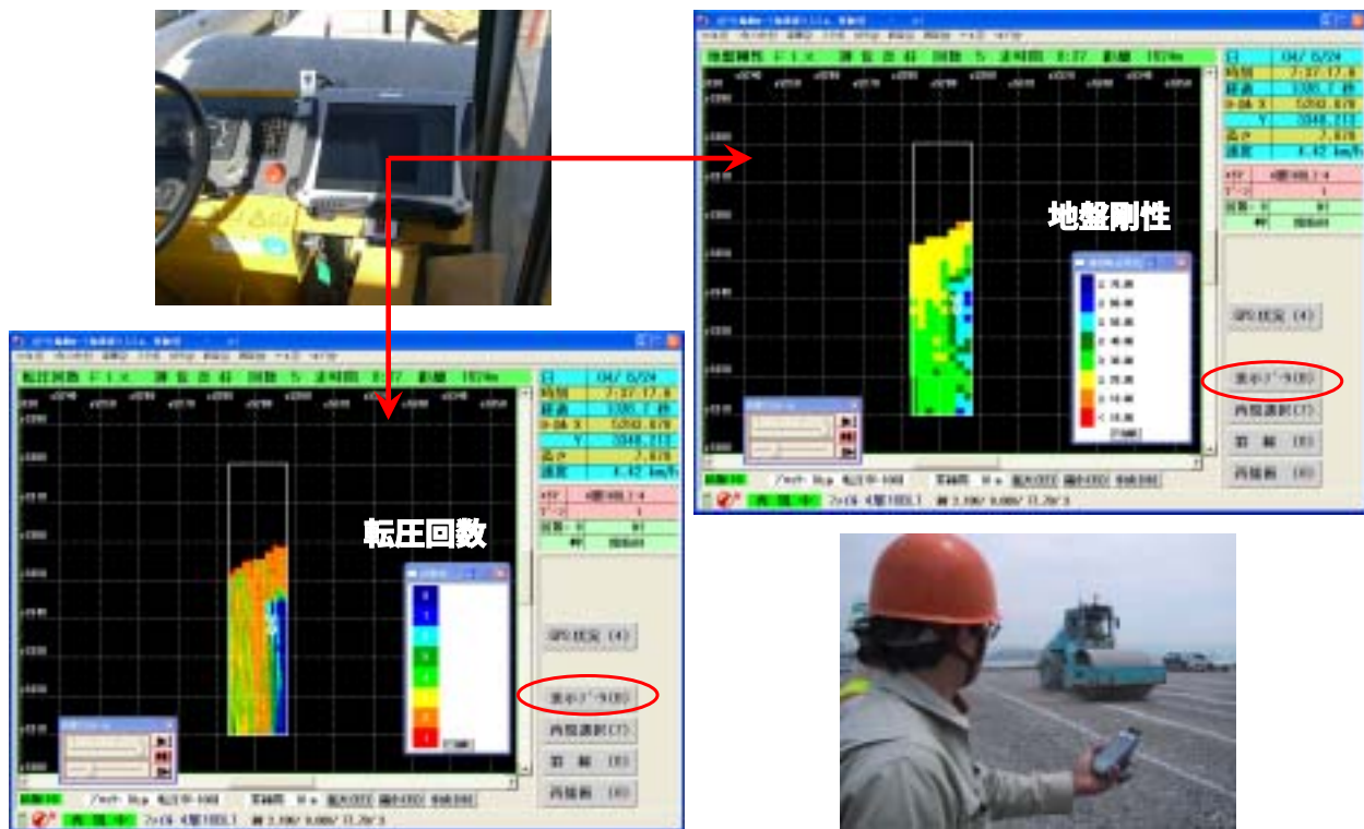
図-7 車載 PC による転圧回数・地盤剛性のリアルタイム表示画面例と PDA による確認状況
