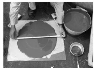
写真-6 シリンダー法によるフロー値の測定試験
