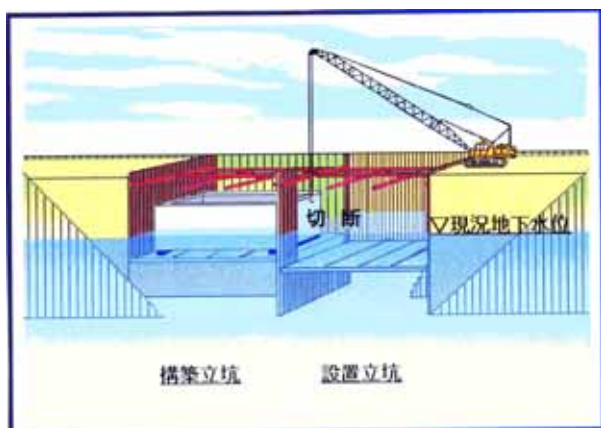
図-11 注水・鋼矢板切断工(step4)
