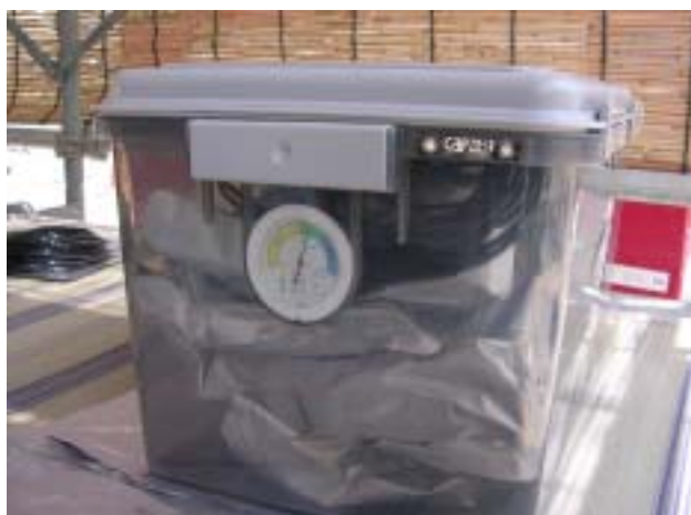
写真-6 乾燥箱（溶接棒溶接材）
