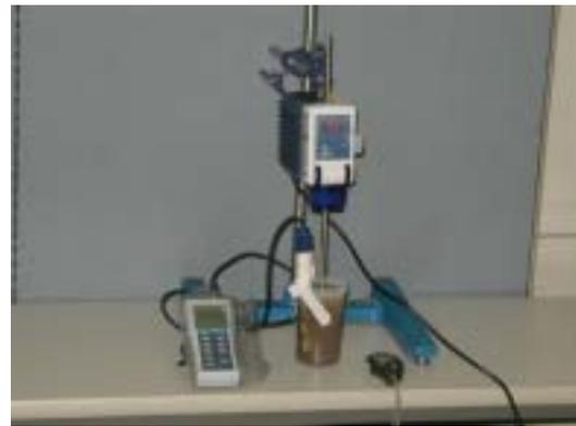
写真-3 電気伝導率を指標とした混合率判定試験状況
