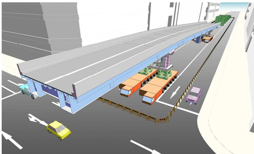
図-1 YSクイックブリッジ工法の施工概要
