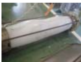
4.4Mpaで膨張始まるが 融着部は膨張せず
