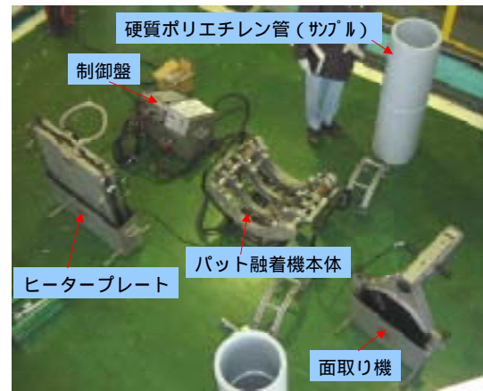
図-12 バット融着に必要な機器類
