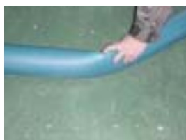
接合部確認 バット部破断無し
