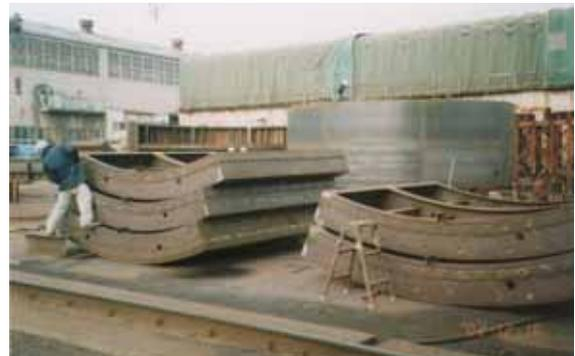
写真-6 鋼製パネル製作状況
